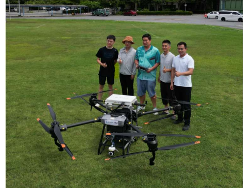
ลักษณะการติดตั้งสถานีลูกข่ายบนอากาศยานไร้คนขับ
