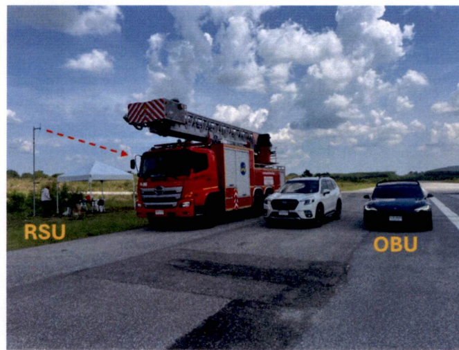
รูปที่ 12 การทดสอบการสื่อสารระหว่างอุปกรณ์ RSU และ OBU แบบ Non-Line-of-Sight (NLOS)
