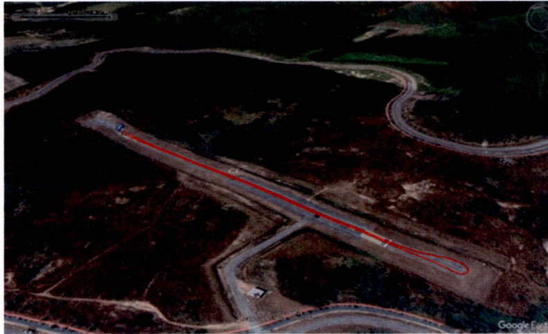
รูปที่ 6 พิกัดตำแหน่งของรถทดสอบต้นแบบที่เคลื่อนที่ไปตามเส้นทางในพื้นที่ลานบิน ณ วังจันทร์วัลเลย์ ขณะทดสอบการสื่อสาร แสดงผลร่วมกับโปรแกรม Google Earth
