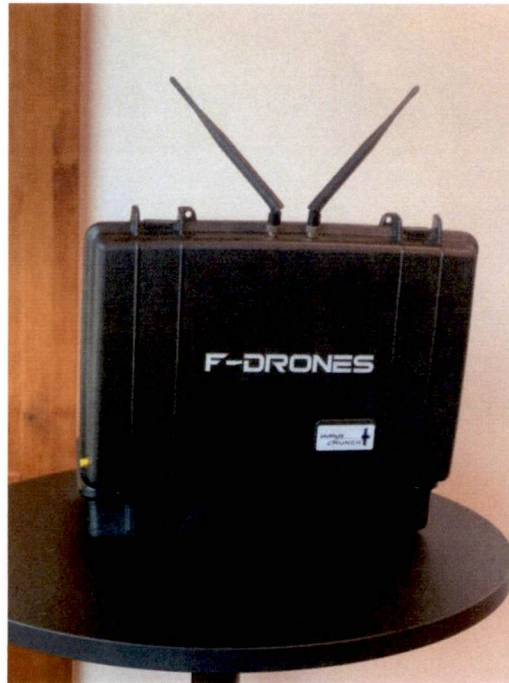
เสาสัญญาณคลื่น 900 MHz ภาคพื้น ติดตั้งที่ Ground Control Station
