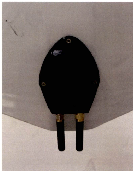
เสาสัญญาณคลื่น 900 MHz ติดตั้งบนอากาศยาน
